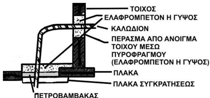
Σχήμα 3.12. Πυροφραγμός πετροβάμβακα και ελαφρομπετόν ή γύψου.
